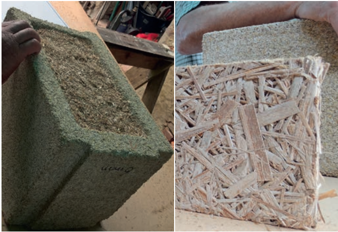
Abbildung 2 und 3: Schilfhohlblock (links) und Rohrkolbenbauplatte (rechts): Stabiler und hochwertiger Baustoff für ein gesundes Wohnklima.
